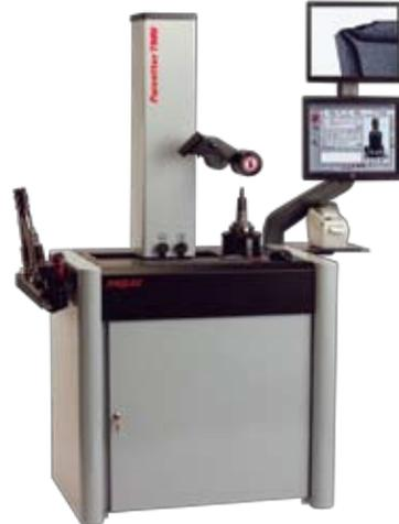
测量最大直径: 420mm
