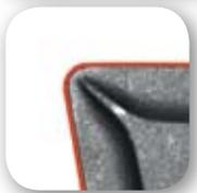
**刀具轨迹：**留下刀具的外形轮廓，对于调整盘铣刀、多刃镗刀，检查切削刃磨损等非常容易。
