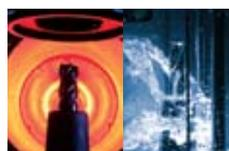
采用高频热感应技术和独有的核心冷却技术
