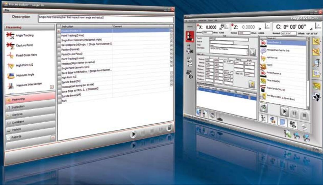
帕莱克CNC系统数据库提供各种标准的自动测量程序，操作者可快速、简便的对程序进行调用和编辑。同时帕莱克CNC系统数据库中包含了各种指令，操作者也可自行编辑测量程序。只需简单的选择添加，便可轻松完成测量程序的编辑。
