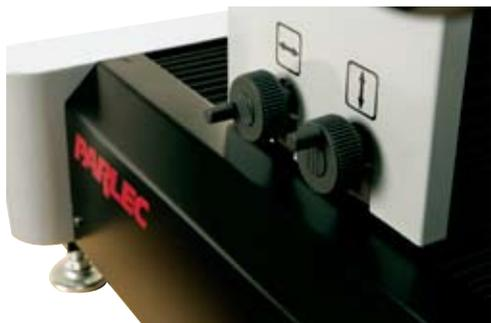
可选微调装置，微调装置最小调节量 1 μm。
