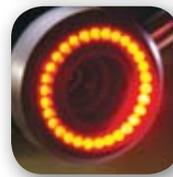
**刀具表面检查：** 通过刀具表面检查灯，可以检查刀具表面的磨损、裂痕、积屑瘤等状况。
