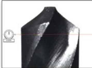
方便快捷的检测刀具圆跳动
