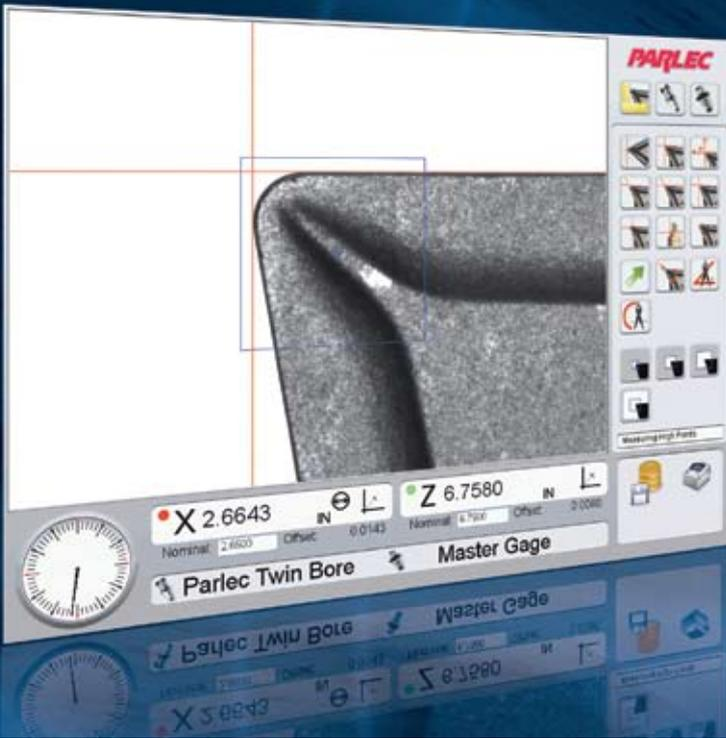
帕莱克PSC刀具测量与检查控制系统应用最先进的数字摄像测量技术。高分辨率的数码成像系统，并通过17"或19"液晶显示器显示图像。动态十字线自动跟踪，自动识别刃形，在屏幕内任意位置都可进行精确测量。
